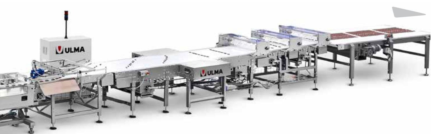
As filas de produto que chegam do túnel de esfriamento são estiradas através de um sistema de esteira dupla em ângulo facilitando assim o alinhamento do produto, necessário para sua introdução ao sistema de alimentação automático.
